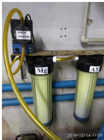
Рисунок 3.15 – Вузол глибокої очистки техногенних розчинів йодиду цезію від домішок важких металів: насос-дозатор і блок патронних фільтрів з магнієм і активним вугіллям
